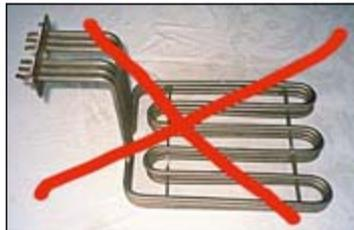
165°C Arbeitstemperatur aufheizt und das gesamte Öl permanent durch die Durchlauferhitzer zirkuliert und erwärmt wird. Tauchsieder Fritteusen überhitzen das Öl punktuell und aggressiv.
